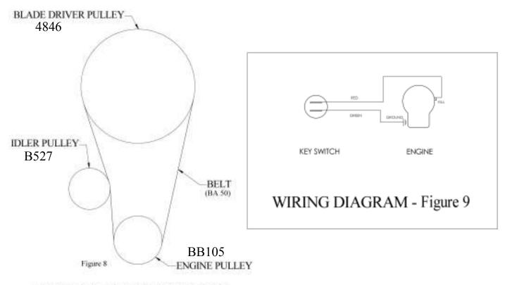
ENGINE PULLEY CONFIGURATION
